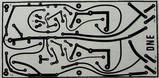
Bild 4. Printplatte für das Netzgerät für positive und negative Spannungen (Maßstab 1 : 2)
